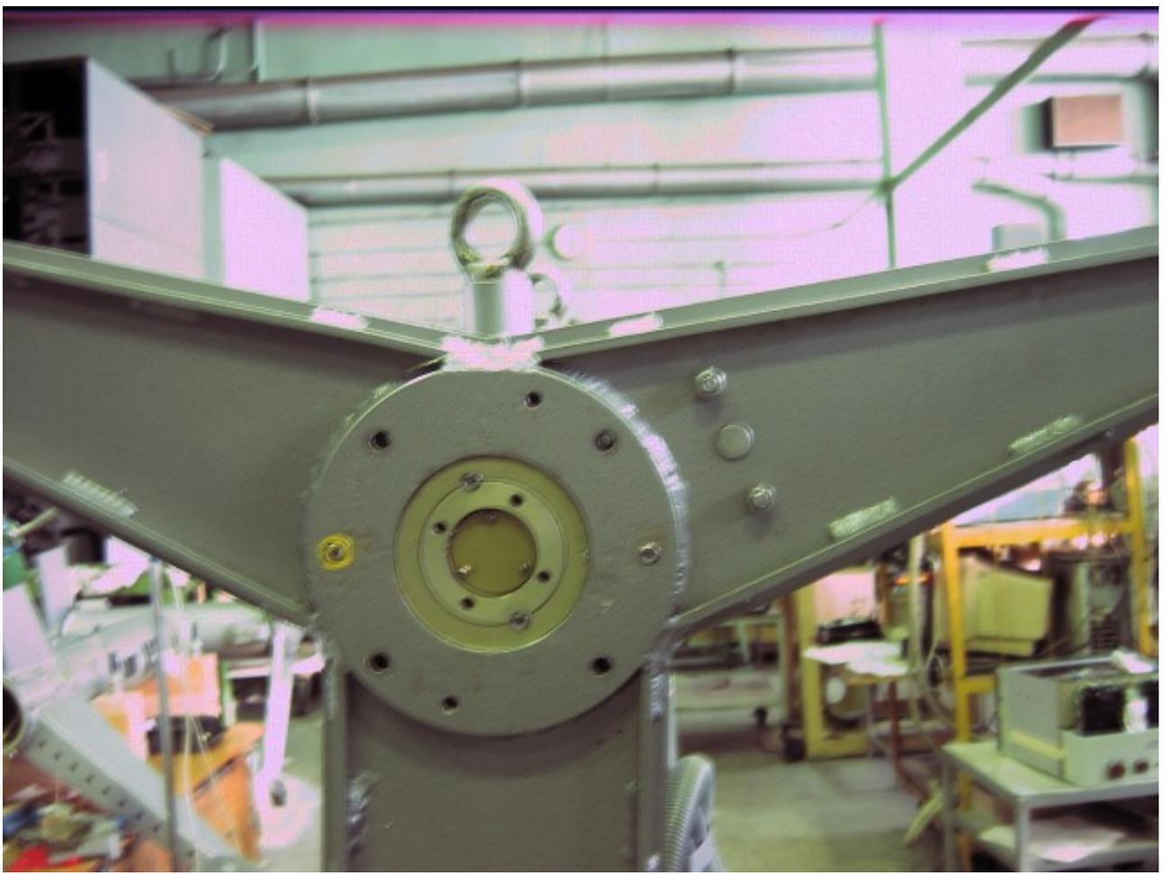
6. Установить съемники - 2 болта М8. Поочередно вкручивать съемники то с одной, то с другой стороны. Рычаг будет постепенно выдвигаться.
