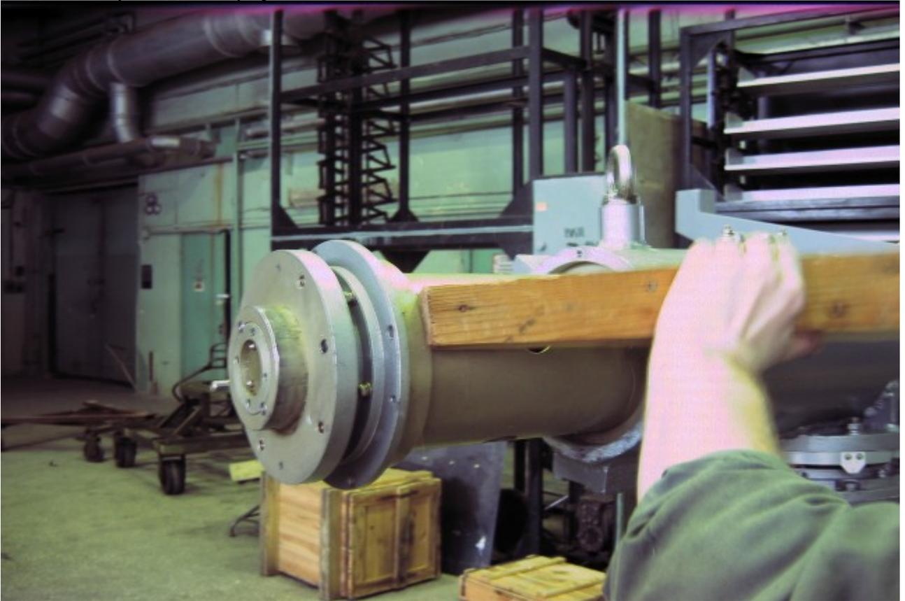
Подбивая то с одной, то с другой стороны, выколотить привод из корпуса окончательно, придерживая снизу.
