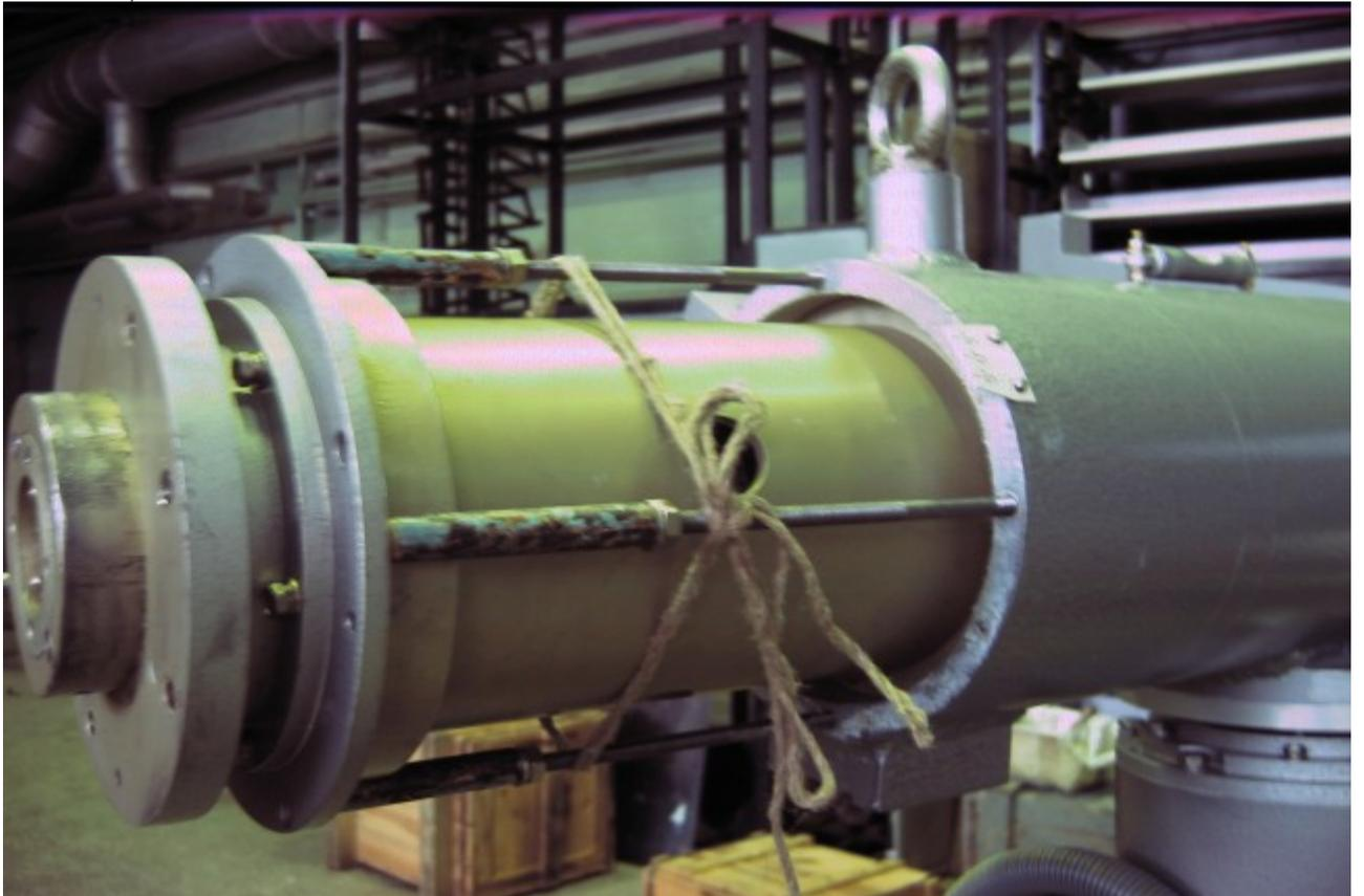
Подкручивать гайки поочередно на каждой шпильке, сдвигая трубку и тем самым выдвигая привод из корпуса.
